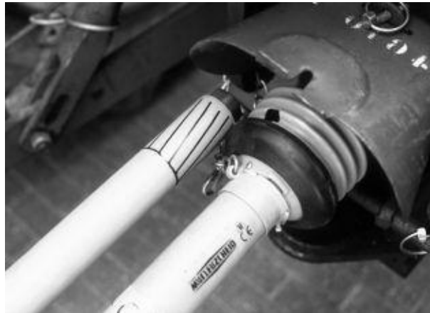
Fig. 1.12 Twee aftaktussenashelften naast elkaar in aangekoppelde situatie. Het gearceerde gedeelte is te lang.
